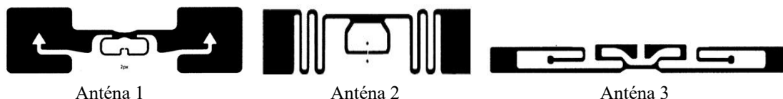
Obrázok 1. Dizajn symetrických dipólových UHF RFID antén
