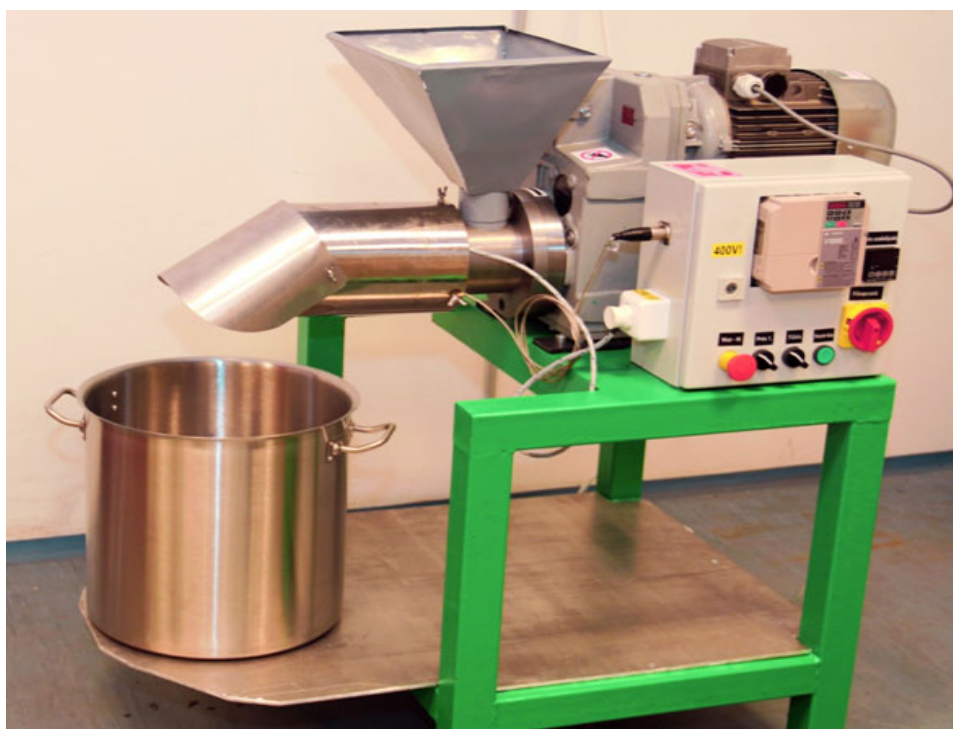
Obrázok 1. Kontinuálny laboratórny jednozávitovkový extrudér (PAŽITNÝ 2022).
