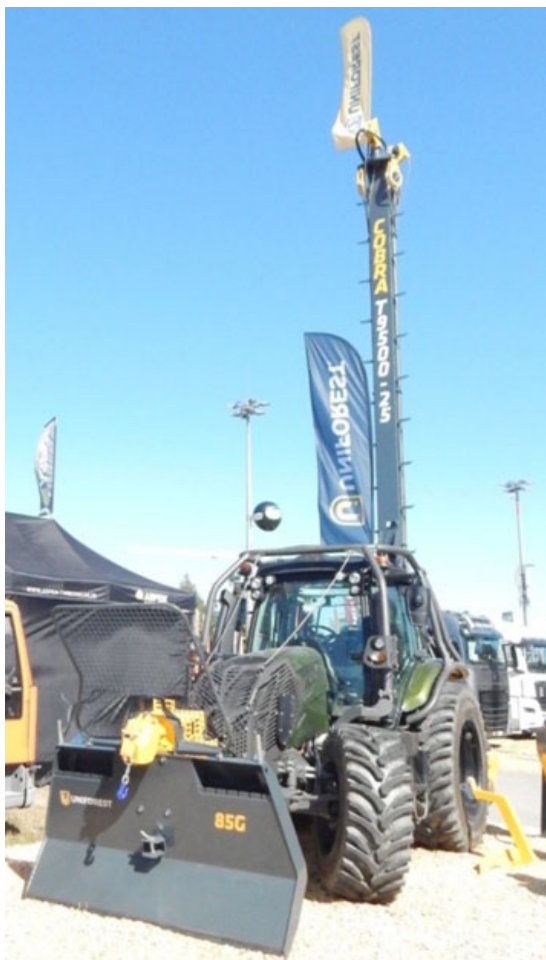
Obrázok 3. Lesnícka lanovka Cobra T9500 pripojená na traktore Valtra (Slamka 2022).
