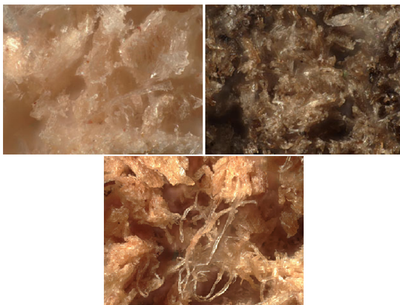
Obrázok 2. Výber mikroskopických snímok vytvorených pomocou digitálneho mikroskopu Keyence VHX-7000: pôvodná vzorka bukovej dendromasy (snímka vľavo), vzorka bukovej dendromasy pedspracovanej parnou extrúziou (snímka v strede) a alkalickou extrúziou (snímka vpravo).
