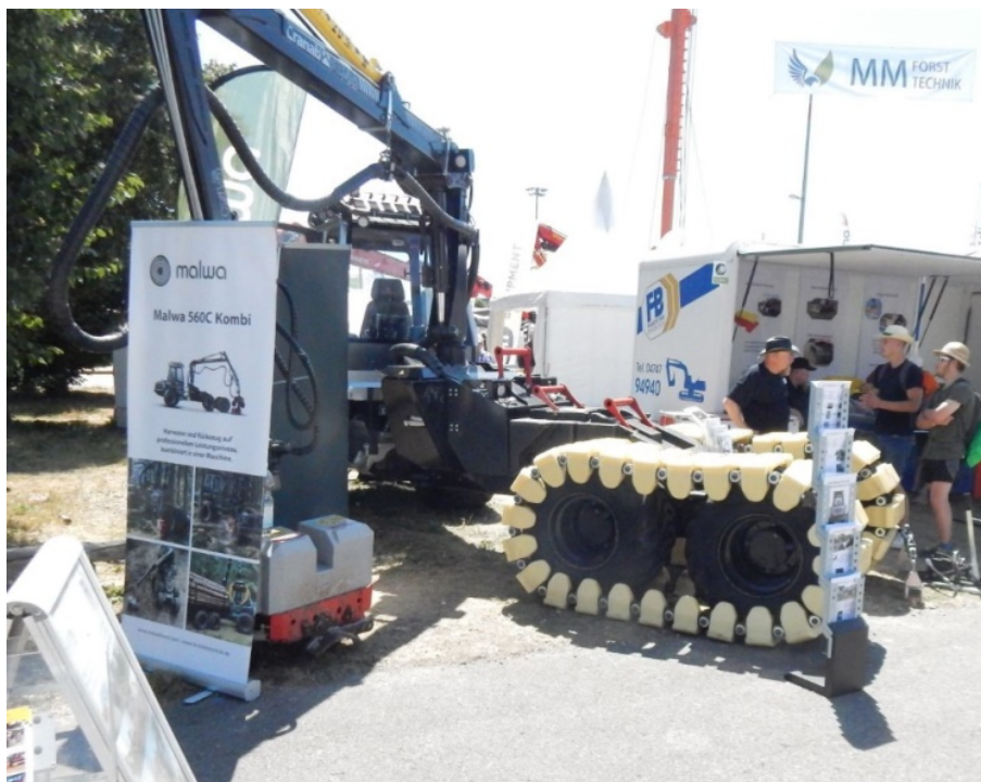
Obrázok 2. Malwa 560C Kombi Harvester/Forwarder s kolesopásmi Felastec.
