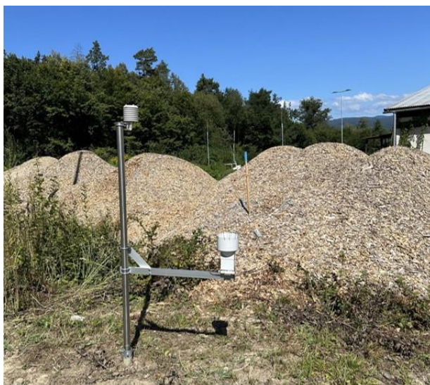
Obrázok 4. Inštalovaná meteostanica v blízkosti experimentálnych hromád pre dlhodobý monitoring atmosférických podmienok.
