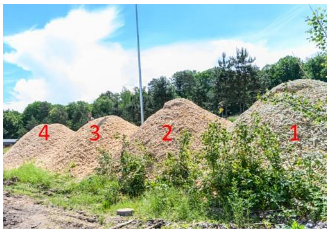
Obrázok 2. Založené experimentálne hromady s aplikovanými fungicídnymi prostriedkami (1-Lignofix, 2 – Tálový olej, 3 – Vápno, 4 – Bez aplikácie v malej časti s retardérom HR PROF)
