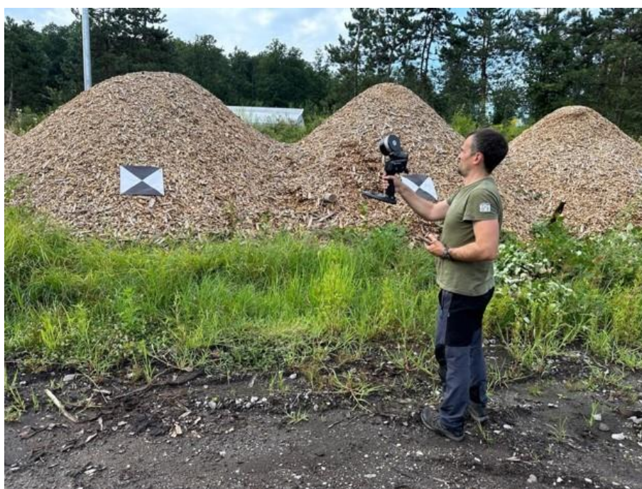
Obrázok 5. Laserové pozemné skenovanie experimentálnych hromád ručným laserovým skenerom Stonex Geoslam X120 GO,
