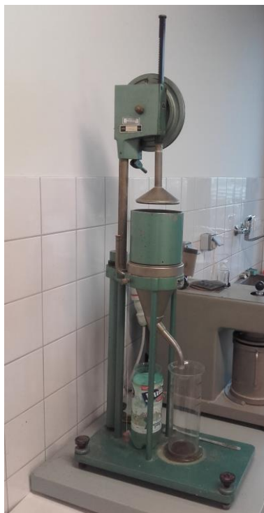
Obrázok 3. Prístroj na stanovenie stupňa mletia materiálu na báze kukurice, drevnej buničiny a ich kombinácie (°SR – stanovenie stupňa Schopper-Riegler).
