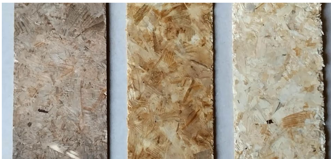
Obrázok 1. Bezspojivé aglomerované materiály zo smrekových hoblín lisované v aerosóle (zľava) 5% vodného roztoku H_2SO_4 ; 5% vodného roztoku NaOH; pH neutrálnom aerosóle. Na farebnosť povrchovej vrstvy výlisku má vplyv použitie kyslého / alkalického / pH-neutrálneho aerosólu pri rovnakých ostatných podmienkach v procese lisovania (obr. 1). Na výslednú farbu povrchu majú samostatne vplyv aj lisovacia teplota a čas – čím je ich hodnota vyššia, tým má výlisok tmavší odtieň.
