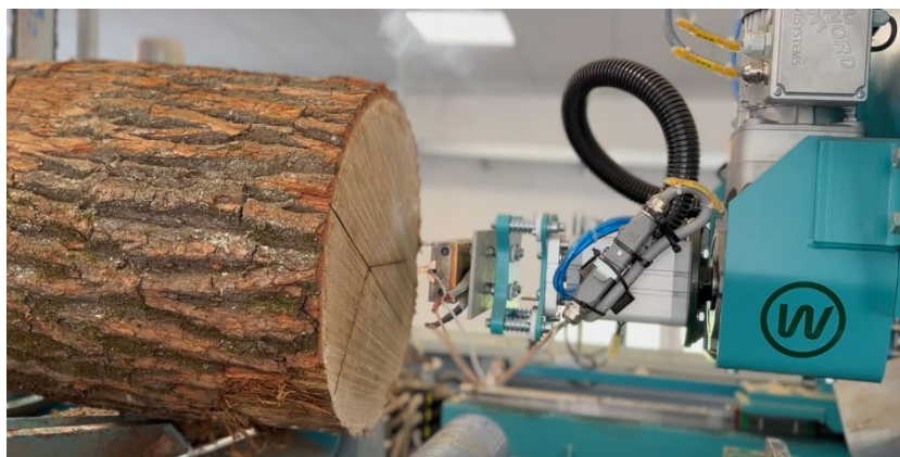
Obrázok 8. Vypaľovacia hlava nainštalovaná na 3D CT skenovacej linke
