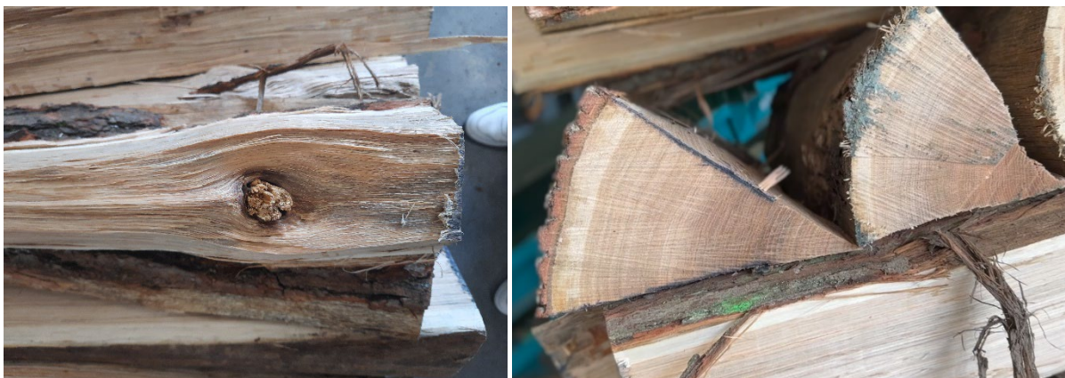
Obrázok 10. Vyštiepnutá časť s hrčou z dubového výrezu na základe CT skenovania
